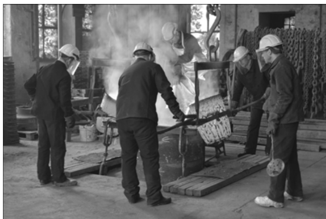
IMMER EIN GROSSER AUGENBLICK, wenn das glühende Metall in die Form fließt. Viele Melzower waren dabei, als in Lauchhammer ihre Glocke gegossen wurde.
